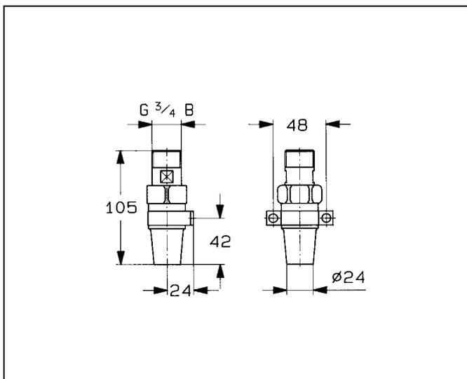
~~**Rohrunterbrecher** für Wandbefestigung, mit Anschlussverschraubung und Abgang mit Lötstützen für Spülrohr DN 20. Messing roh.~~
