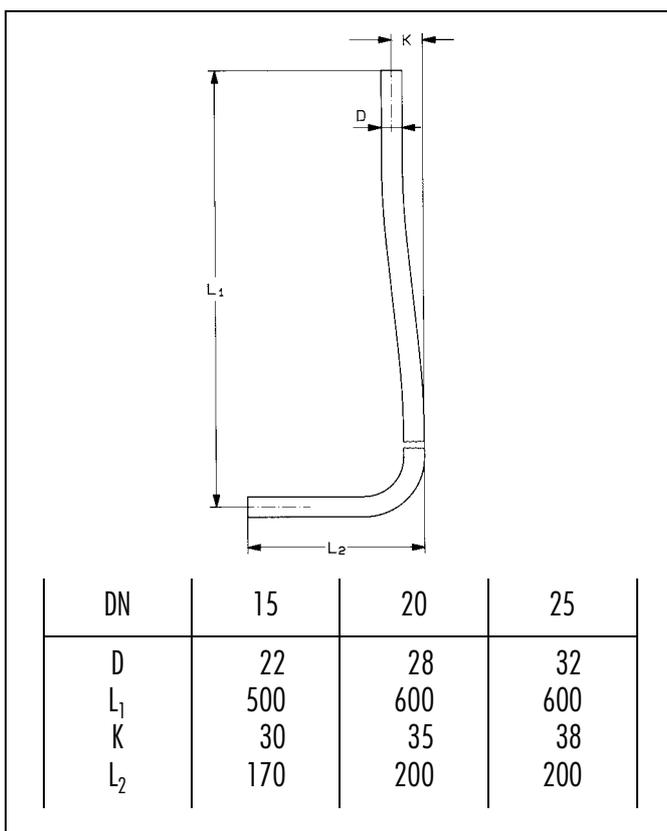
**WC-Spülrohr**, schwach gekröpft zum Anschluss von Aufputzdruckspülern an Standklosetts. Messing poliert verchromt.
