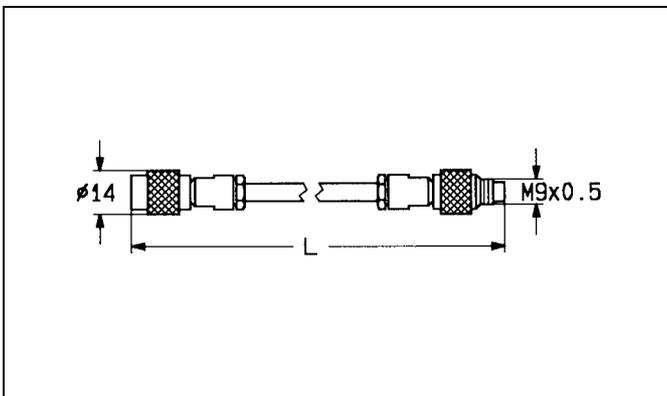
**Sensorverlängerungskabel für AQUAMAT** wasserdichte Ausführung.
