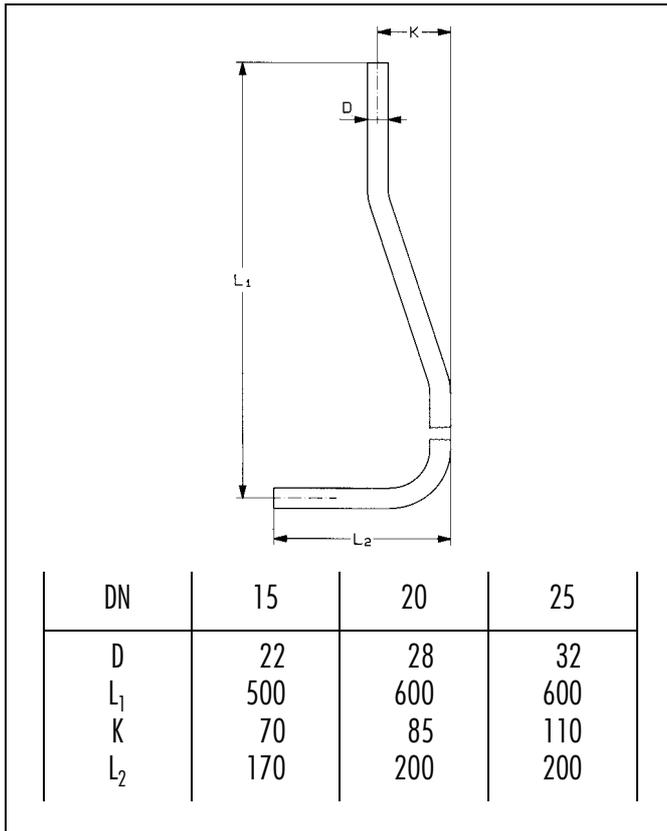
**WC-Spülrohr**, stark gekröpft zum Anschluss von Aufputzdruckspülern an Standklosetts. Messing poliert verchromt.
